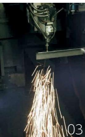
03. FG-220 DDLによる長尺材の高精度3次元加工
